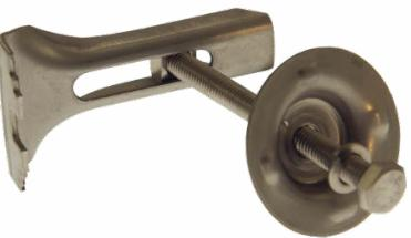
O-clips compleet worden gebruikt voor het bevestigen van roosters met open of gesloten oppervlak met maas 38x38 / 40x40 door middel van klemmen op het dragend profiel. Deze clip is eenvoudig te monteren zonder te boren in de onderconstructie.
